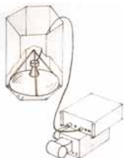
Aparatura sonaru „SAMOS-1” z fotograficzną rejestracją echa.)
