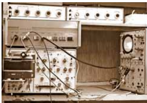
Aparatura sonaru „SAMOS-1” z fotograficzną rejestracją echa.)
